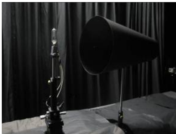
圖 2-17、捉光器之設計與架設
