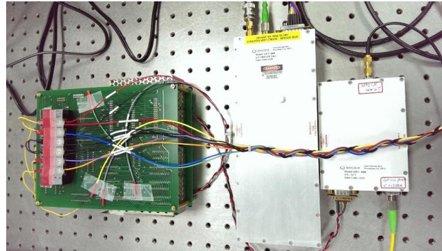
圖 2.2.8. 光發射器、光接收器與搭配之直流電源驅動模組
