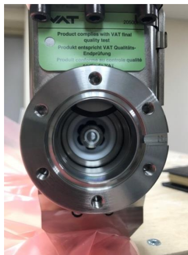
圖 5-1-3、無視窗偵測機構與 CF35 (DN40) flange
