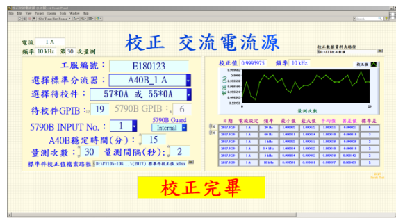
圖 1-3-15、交流電流源之自動化校正程式畫面
