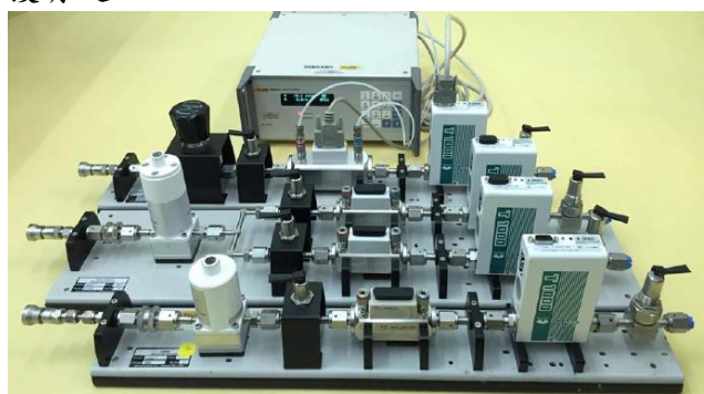
圖1-2-11、低壓氣體流量國際比對傳遞標準件
