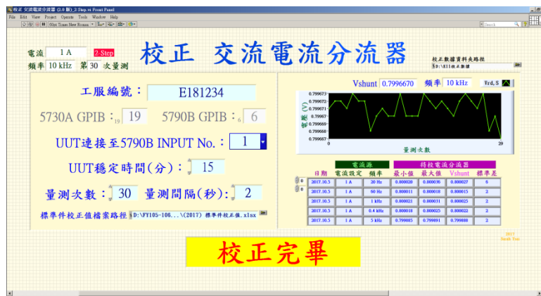
圖 1-3-20、交流電流分流器之自動化校正程式畫面
