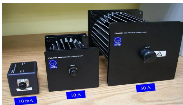
圖 1-3-10、電流分流器 FLUKE A40B 系列之部份實體照片 (輸入電流分別為 10 mA、10 A、50 A)
