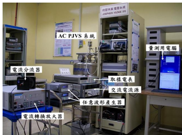
圖 1-3-9、AC PJVS 系統執行電流分流器相位偏移校正之實體照片
