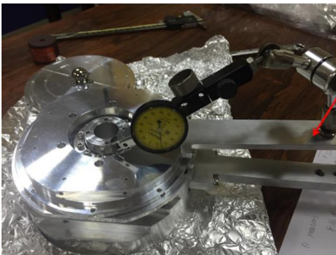
圖 2-2-5、實測高真空高精密二環旋轉台樣品軸與偵測器軸之共軸誤差
