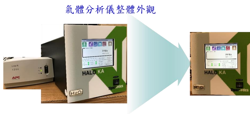
圖 5-2-1、聲學氣體溫度計之氣體分析儀整體外觀
