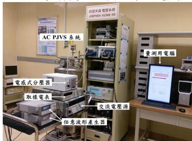
圖 1-3-6、AC PJVS 系統執行 IVD 分壓比率誤差校正之實體照片
