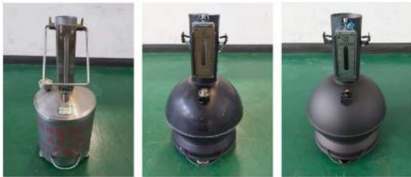
圖 4-8、待測量桶側視圖(左：不鏽鋼量桶，中：黑桶，右：新購黑桶)
