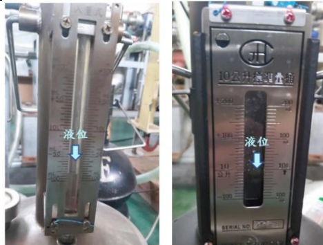
圖 4-12、不鏽鋼桶與黑桶視讀弧形液面和刻度
