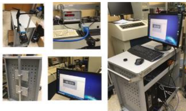
圖 2-17、N04 影像擷取判讀系統與可調式機架實體圖
