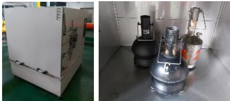
圖 4-11、恆溫恆濕試驗機外觀及待測量桶至入恆溫恆濕試驗機內
