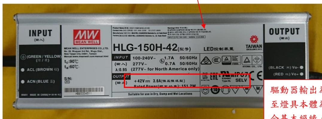
驅動器輸出為 SELV，驅動器後端至燈具本體為 III 類結構，僅須符合基本絕緣。
