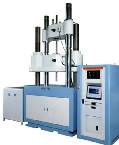
圖1 大型扣件拉伸試驗機
