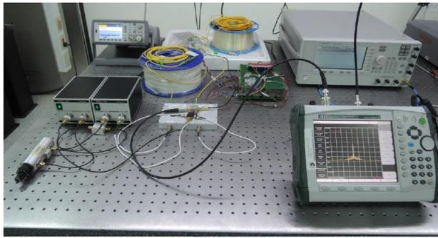
圖 3.8 雙光迴路光電振盪器實驗架構圖及照片
